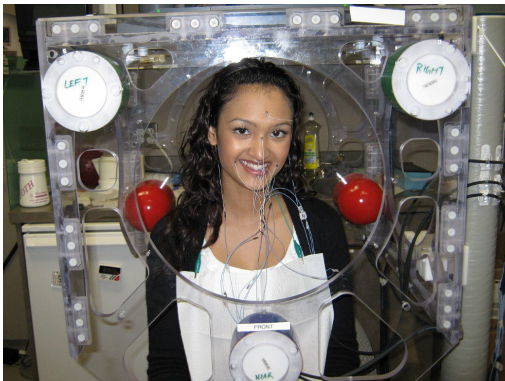
Figuur 1: De proefpersoon zit in een kubus, waarin 6 transmitters bevestigd zijn. In deze foto zijn er twee rood gekleurde transmitters aan de achterkant te zien en 3 aan de voorkant (“left”, “right” en “front”); de zesde is verborgen achter de proefpersoon. De spreker heeft spoeltjes op het voorhoofd, achter de oren, boven de mondhoeken en op de neusbrug. Deze dienen als referentie. De spoeltjes voor de articulatoren zijn op de onderlip, bovenlip en de tong bevestigd.
